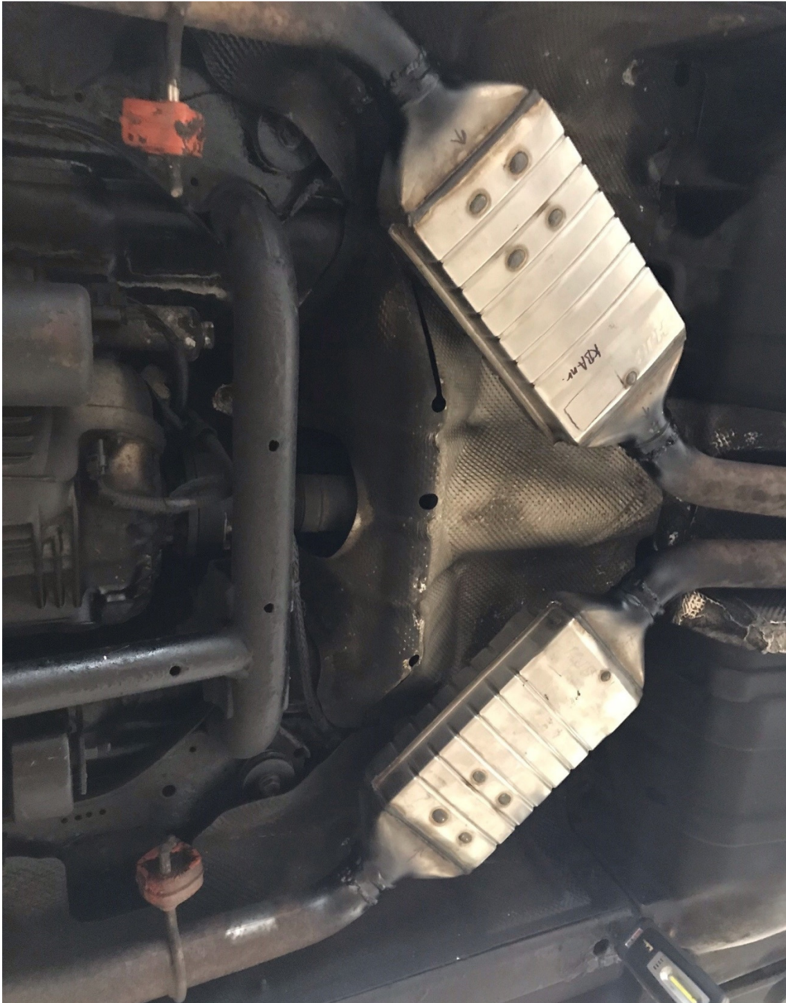
2 stk. DPF-07 DPF monteret parallelt på mellemrør på Range Rover (L322) 3,6 TdV8 Filtrene kan enten svejdes direkte på bilens udstødning, eller monteret vha. bøjninger, klamps og rørsamlere, så filtrene af afmonteres.
